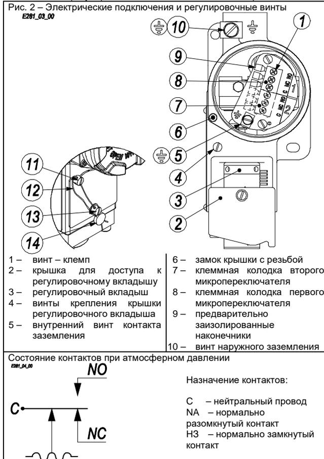
Влияние направления вращения регулировочного вкладыша указано на клейкой этикетке. Поверните винт, вставив штифт 3 мм в диаметре в отверстия на регулировочном винте (рис. 2).
